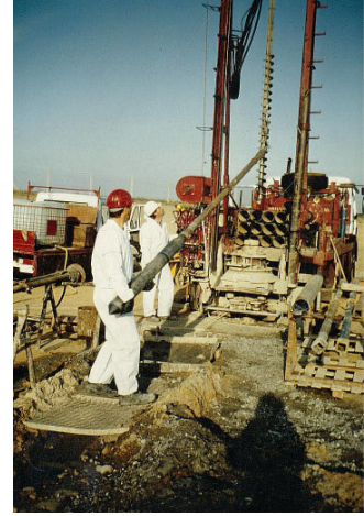
Einsatz der ORKUS-Sonde für die Probenentnahme
