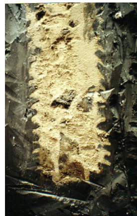
Dichtmasse nach Einsatz der Bohrlochfräse
