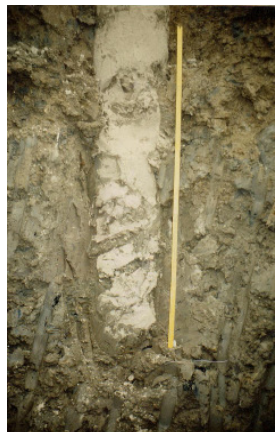
Verpresste Dichtmasse ohne Verzahnung im Bohrloch
