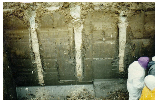
Freilegen der verpressten Bohrlocher und der plombierten Entnahmebereiche auf einem Teststandort in Schleswig-Holstein
