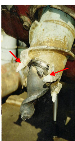
Hohlbohrschnecke mit modifiziertem Vorschneider und Verpressöffnungen (rote Pfeile) zur Injektion der Dichtungssuspension
