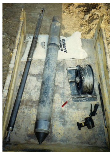
ORKUS-Sonde (Mitte) mit mechanischem Öffnungsgestänge (links)
