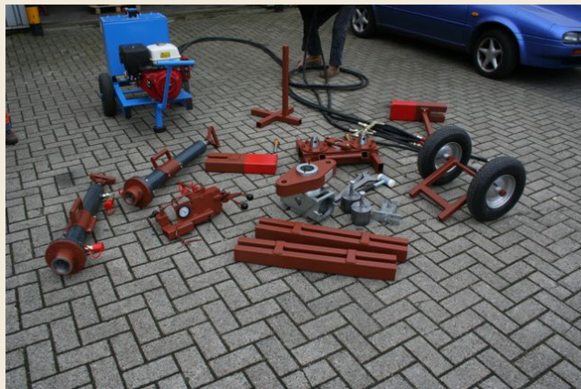
Looses Sondiergerät zum Transport zerlegt
