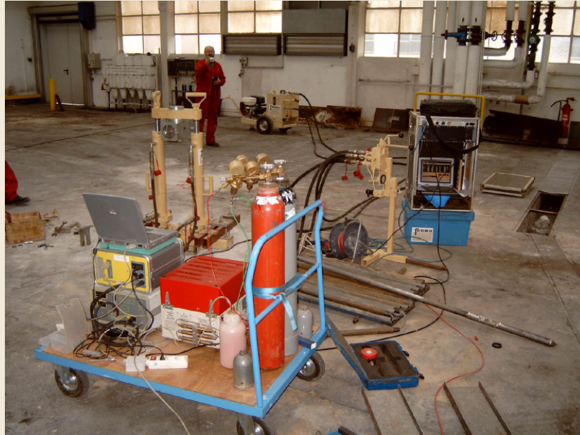
Sondierungen mit CPT und MIP in Gebäuden
