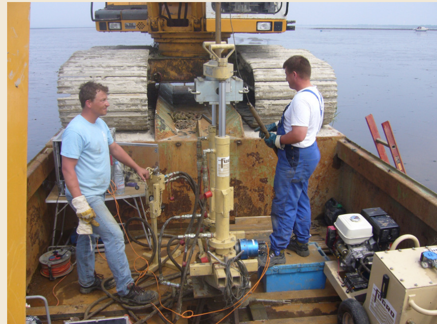
Loses Sondiergerät im „Schlickrutscher“
